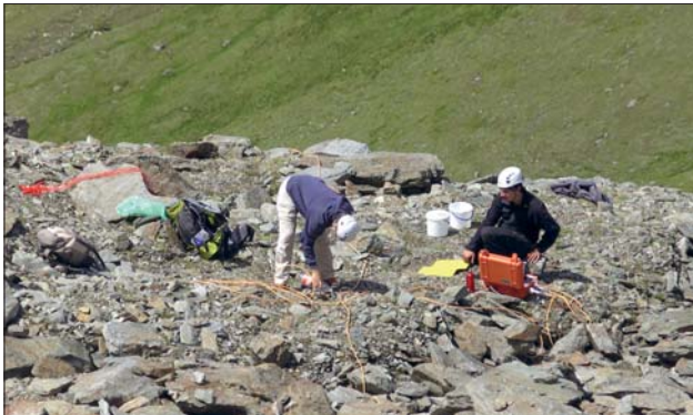
Um den Untergrund zu erkunden werden geophysikalische Messungen wie z.B. mittels Geoelektrik durchgeführt (Foto: B. FRIEDL).
